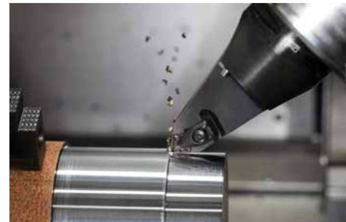
Rysunek 2: Większa trwałość GC4325 jest zasługą idealnego stanu ostrza, które pracuje z dużą wydajnością, umożliwiając zarazem uzyskanie małej chropowatości powierzchni.
