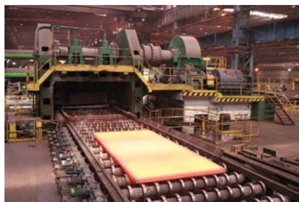
Fotografia 1: produkcja blachy grubej w ISD Huta Częstochowa sp. z o.o.
