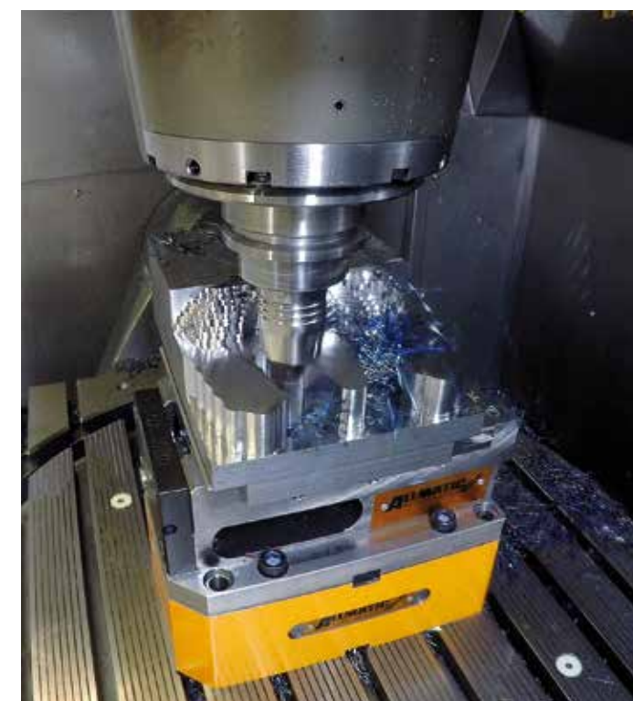
Rysunek 5 Frez 12 mm i głębokość skrawania 24 mm
