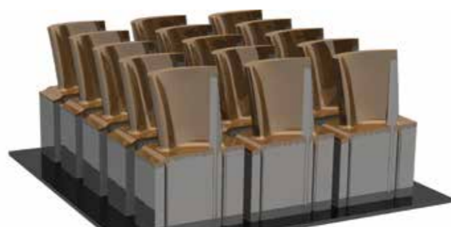
Ilustracja 2. Przykład rozkładu przedmiotów drukowanych 3D z metalu – nesting 2D (NX CAD/CAM)
