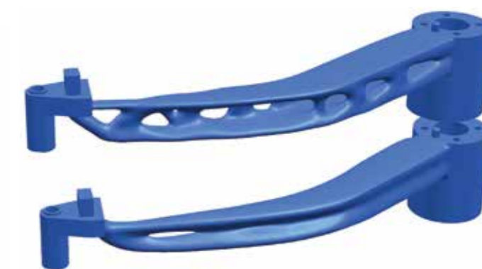
Ilustracja 5. Przykład analizy topologii – NX CAD/CAM
