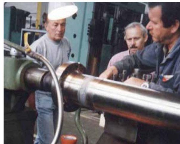
Fot. 2. Regeneracja czopa wału kompozytem Belzona® (1111)
