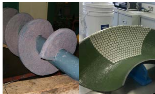
Fot. 1. Ochrona kompozytami Belzona® (1811) i (1812) przed ścieraniem: a) podajnika ślimakowego, b) kolana przewodu pyłowego
