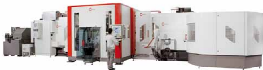
System robota RS 2 zaadaptowany do dwóch centrów obróbczych C 40 U dynamic. Jeden robot obsługuje dwie maszyny. Obie maszyny mogą pracować równolegle w trybie ręcznym lub automatycznym.
