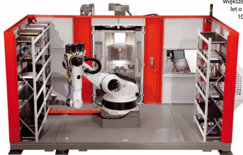
System robota z dwoma magazynami palet podczas załadunku wysokowydajnego 5-osiowego centrum obróbczego (dla lepszej widoczności na zdjęciu brak jest przedniej ściany obudowy).
